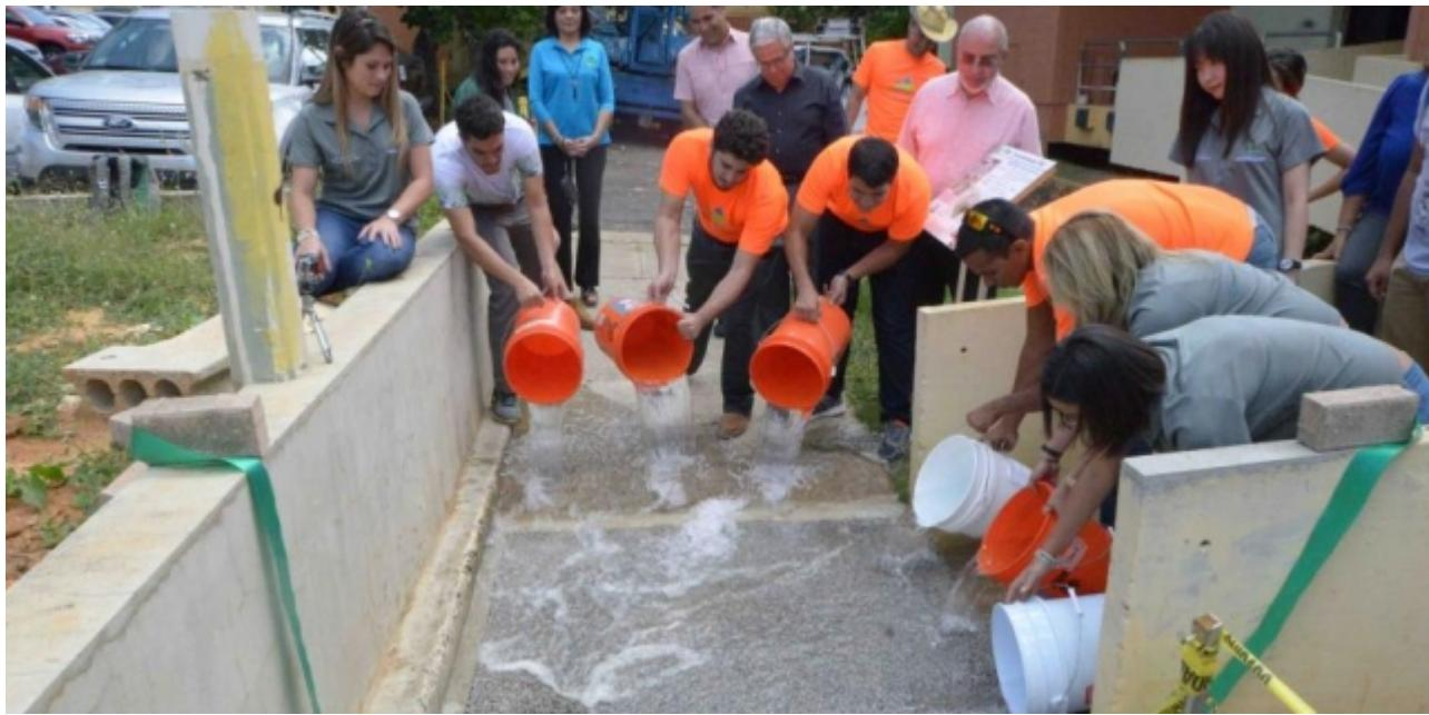
Prueba con el hormigón permeable, novedoso material que filtra el agua y permite que llegue a la tierra, en lugar de acumularse en la superficie. (Suministrada / Prensa RUM)
