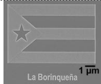
Imagen "tallada" con electrones (el punto sobre la "i" es de 49 nm de diámetro)
